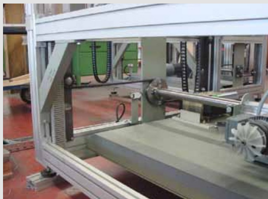
II. 2: Anodowane elementy ramy (usunięte osłony). Pic. 2: Anodized parts of the chassis (covers removed).
