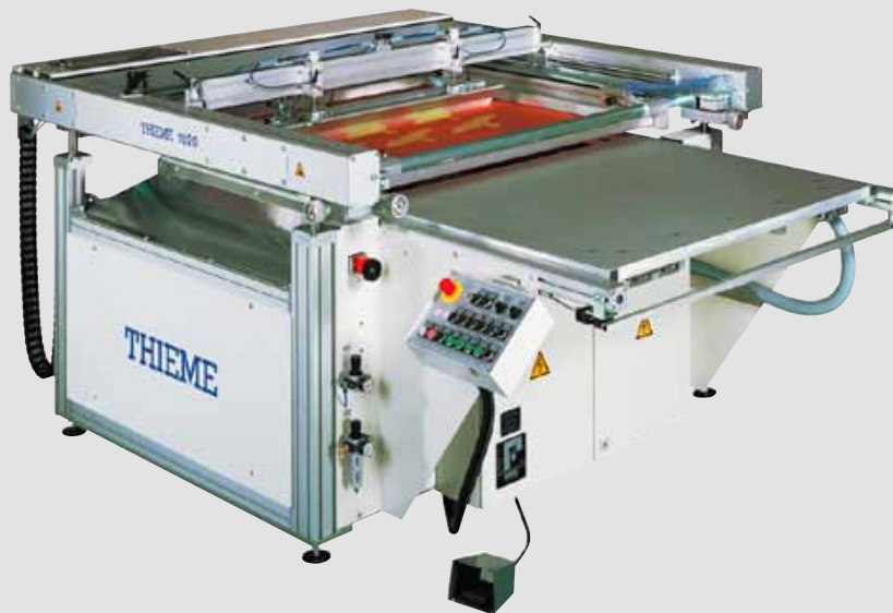
II. 1: THIEME 1000 E do nadruku na foliach i płytach obwodów drukowanych. Pic. 1: THIEME 1000 E for printing on foils and conductor boards.
