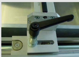
Il. 9: Ukośne położenie zespołu rakla. Pic. 9: Diagonal squeegee position.
