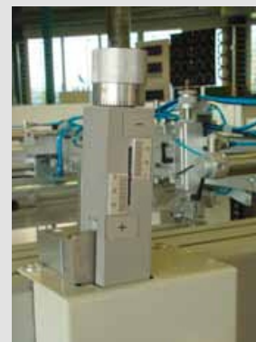
Il. 20: Mechanizm kompensacji naciągu siatki sitodrukowej w urządzeniu THIEME 1000 E. Pic. 20: Screen elongation compensation on the THIEME 1000 E.
