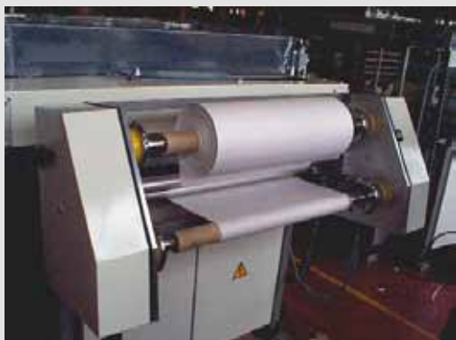
Il. 18: Mechanizm CleanPrint (widok części tylnej maszyny). Pic. 18: CleanPrint ink removal system (on back of press).
