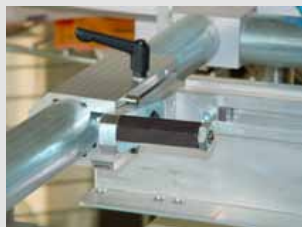
Il. 7: Ogranicznik (uniesiony) mechanizmu centrowania ramy sita. Pic. 7: Pin (flipped up) for Frame Centering.
