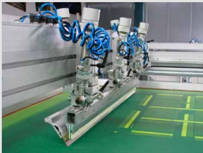
Il. 16: Zabezpieczenie przed skapywaniem podczas zalewania. Pic.16: Anti-drip unit by flooding.
