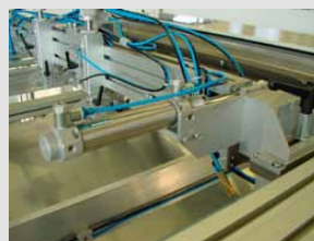
Il. 10: Opcjonalny mechanizm obracania rakla o 90°. Pic. 10: Optional 90° squeegee swivel device.
