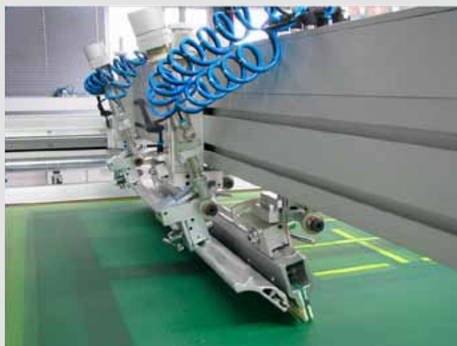
Il. 17: Zabezpieczenie przed skapywaniem podczas drukowania. Pic.17: Anti-drip unit by printing.
