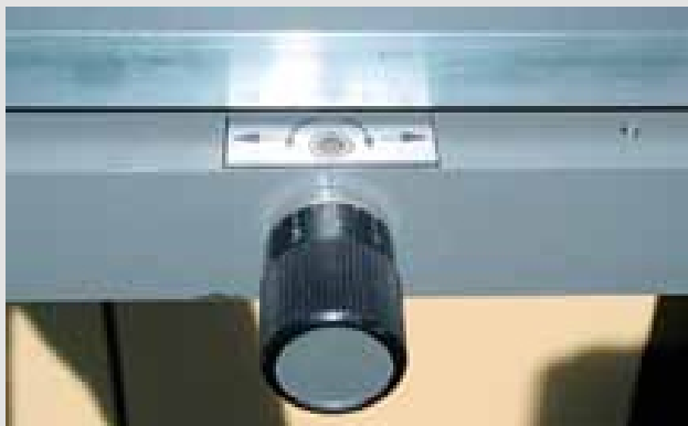
Il. 5: Regulacja położenia stołu drukarskiego. Pic. 5: Adjuster for printing table position.
