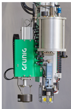
Głowica klejąca z miernikiem napięcia siatki
