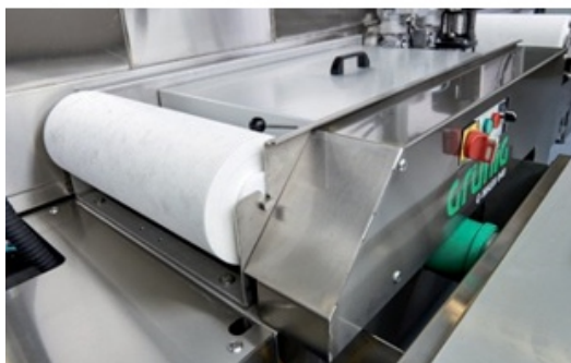
Zbiornik o obiegu zamkniętym z filtrem
