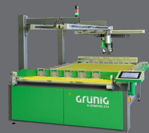
G-STRETCH 275 UV BOND LED, automatyczny system naciągania i klejenia siatki
