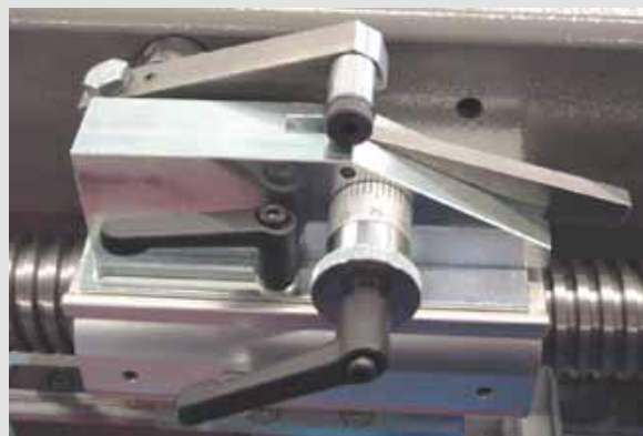
Il. 9: Funkcja podnoszenia sita. Pic. 9: Peel off device.
