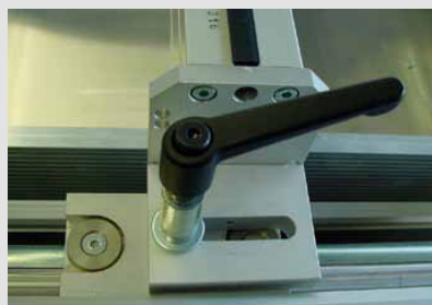
II. 6: Ukośne położenie zespołu rakla. Pic. 6: Diagonal squeegee position.
