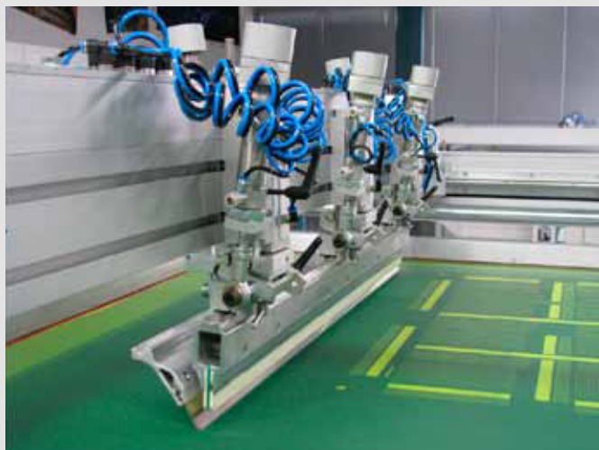
Il. 11: Zabezpieczenie przed skapywaniem podczas drukowania. Pic. 11: Anti-drip protection during printing.
