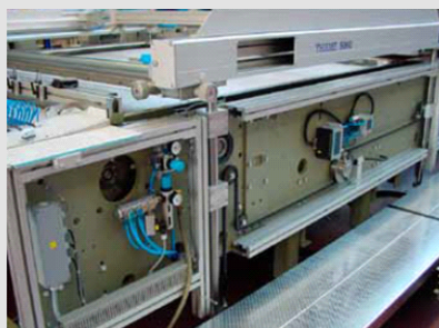
Il. 2: Rama podstawy THIEME 5000 (zdjęte osłony). Pic. 2: Basic chassis of the THIEME 5000 (without panellings).
