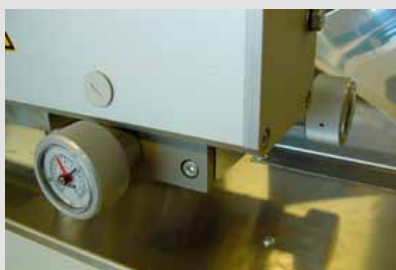
Il. 6: Wrzeczona mikrometryczne do dokładnej regulacji położenia sita. Pic. 6: Micrometer spindles for the screen fine tuning.
