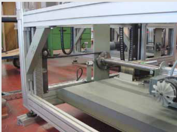
Il. 2: Anodowane elementy ramy.
