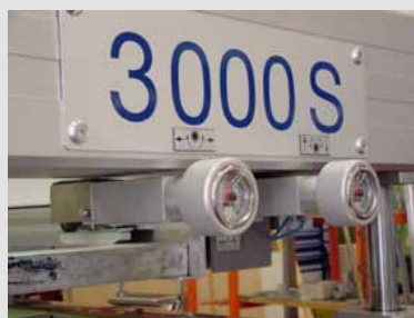
Il. 3: Wrzeciona mikrometryczne zamontowane bezpośrednio przy szynie sita.
