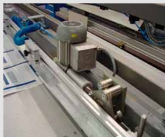
Il. 5: Silnikowa precyzyjna regulacja sita (zdjęte osłony ochronne). Pic. 5: Motorized peel-off (covers removed).
