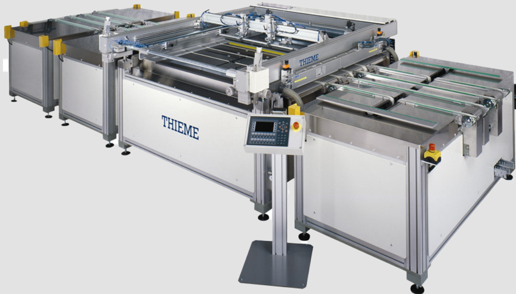
Il. 1: THIEME 3000 GS do nadruku na szkle i innych sztywnych materiałach. Pic. 1: THIEME 3000 GS prints on glass and other rigid substrates.
