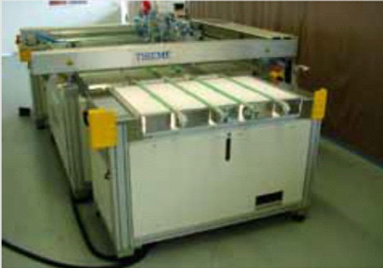
Il. 17: Odbiór z maszyny ze zintegrowanym stołem świetlnym (opcjonalnie). Pic. 17: Delivery station with an integrated light table (option).
