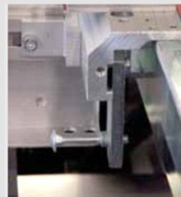
Il. 11: Ogranicznik ramy sita. Pic.11: Screen frame alignment pin.
