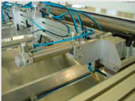
Il. 14: Opcjonalne urządzenie obracające wycieraczkę o 90°. Pic. 14: Optional 90° squeegee swivel device.
