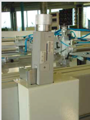
Il. 22: Mechanizm kompensacji naciągu siatki sitodrukowej w urządzeniu THIEME 3000 GS. Pic.22: Screen elongation compensation on the THIEME 3000 GS.
