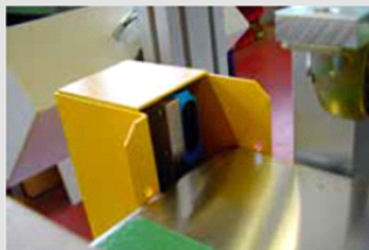
Il. 5: Czujnik optyczny (punkt wstępnego wyłączenia) w obszarze wstępnego wyśrodkowania. Pic.5: Light scanner (stop point) in the precentering station.
