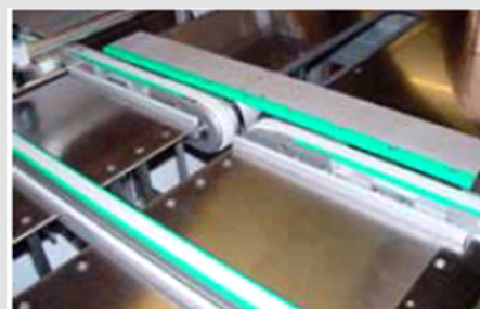
Il. 4: Podzielony zewnętrzny przenośnik taśmowy z suwakami centrującymi. Pic. 4: Separated, outer conveyor belt with centering pusher.
