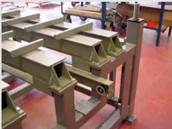
Il. 2: Spawana, obrabiana mechanicznie i skręcana podstawa. Pic. 2: Welded, machined and bolted chassis.
