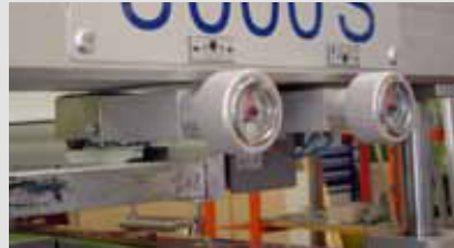
Il. 7: Wrzeczona mikrometryczne zamontowane bezpośrednio przy szynie sita. Pic. 7: Micrometer spindle directly mounted on the screen rail.
