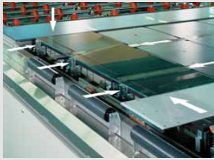
Il. 4: W pełni automatyczne wyśrodkowanie względem bocznych ograniczników stałych. Pic. 4: Automatic panel centering against fixed alignment pins on the side.
