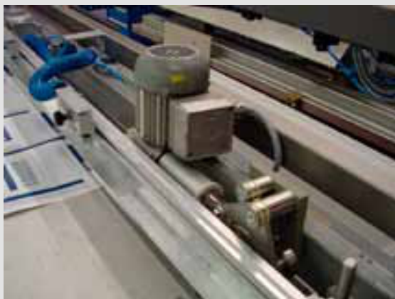
Il. 8: Silnikowa precyzyjna regulacja sita (zdjęte osłony ochronne). Pic. 8: Motor-driven peel-off system (guarding removed).
