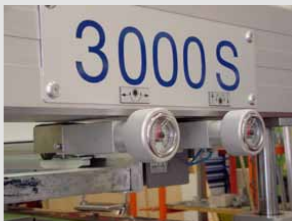
Il. 3: Wrzeciona mikrometryczne zamontowane bezpośrednio przy szynie sita. Pic. 3: Micro spindles directly mounted to the screen support bar.
