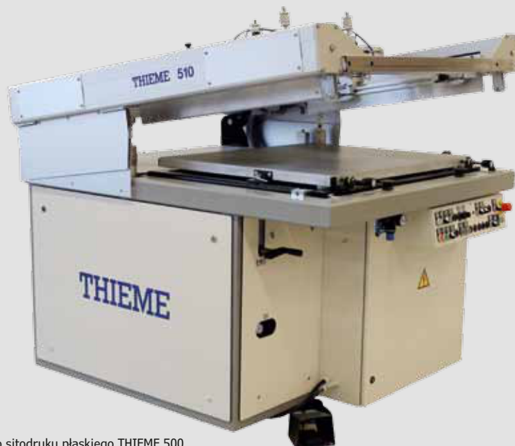
Il. 1: Półautomatyczna maszyna do sitodruku płaskiego THIEME 500. Pic. 1: THIEME 500 semi-automatic flatbed screen printing machine.
